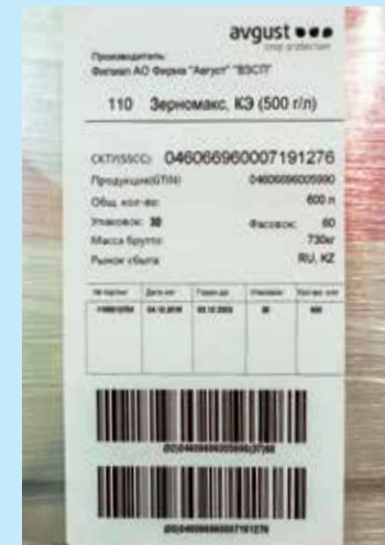
Палетный ярлык с кодом транспортной упаковки (SSCC) из 18 цифр в читаемом виде и в виде линейного штрих-кода. Содержит индивидуальный серийный номер транспортного пакета, включающий информацию о содержащихся в нем коробах и соответствующий линейный штрих-код
