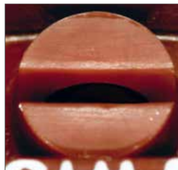
После 200 часов работы с кремниевой кислотой (размер капель 300 мкм, давление 2 бар) отверстие щелевой форсунки стало на 20 - 30 % шире.
